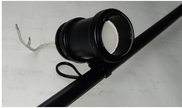
Рисунок 1 – Точечный «трековый» светильник в собранном и покрашенном виде
