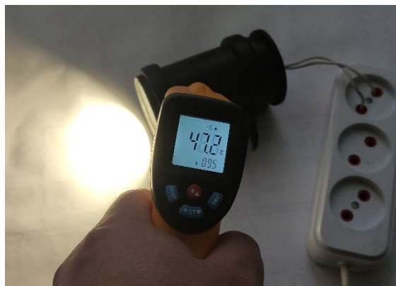
Рисунок 3 – Температура светильника после часа работы
