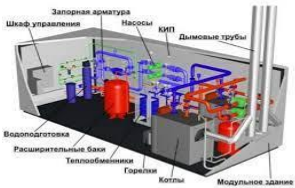
Рисунок 3 - Устройство котельных
