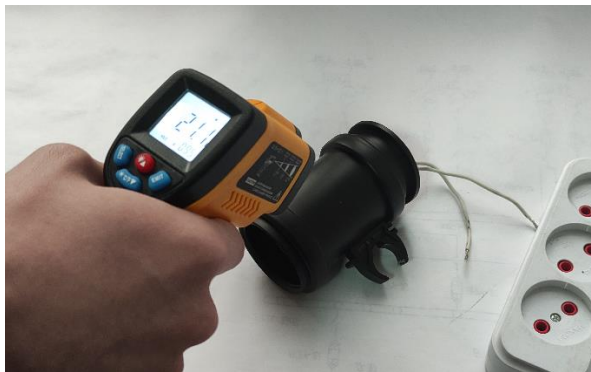
Рисунок 2 – Температура светильника при комнатной температуре.
